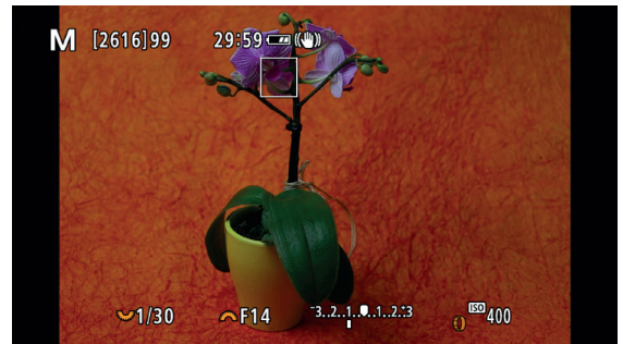
In diesem steht der Indikator auf -1, das heißt das Foto ist um eine Blende dunkler.
